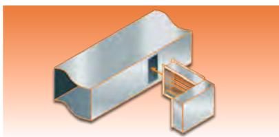
Les serpentins électriques à insertion sont conçus pour permettre de glisser le cadre entier dans le conduit. La construction d'un système avec serpentins électriques à insertion permet l'installation de tous les conduits avant que les serpentins électriques ne soient disponibles.
