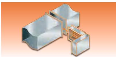
Les serpentins électriques à brides sont conçus pour faire partie intégrante du conduit. Une bride standard de 1" (25,4mm) autour du châssis permet sa fixation au conduit.
